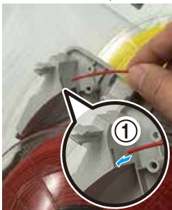
Place the filament into the appropriate entrance. 将料丝穿入图示方形孔。 필라멘트를 해당 구멍에 넣을 것.
