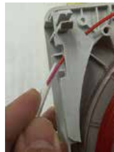
Place the filament into the tube. 将料丝插入软管中。 튜브에 필라멘트를 넣을 것.
