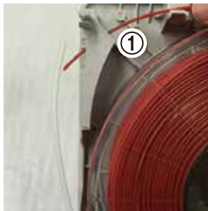
Place the filament into the appropriate entrance. 将料丝穿入图示方形孔。 필라멘트를 해당 구멍에 넣을 것.
